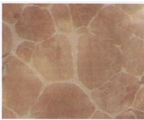
Obrázek 23. Fotografie nábrusu vzorku s belitickými zrnky 60
