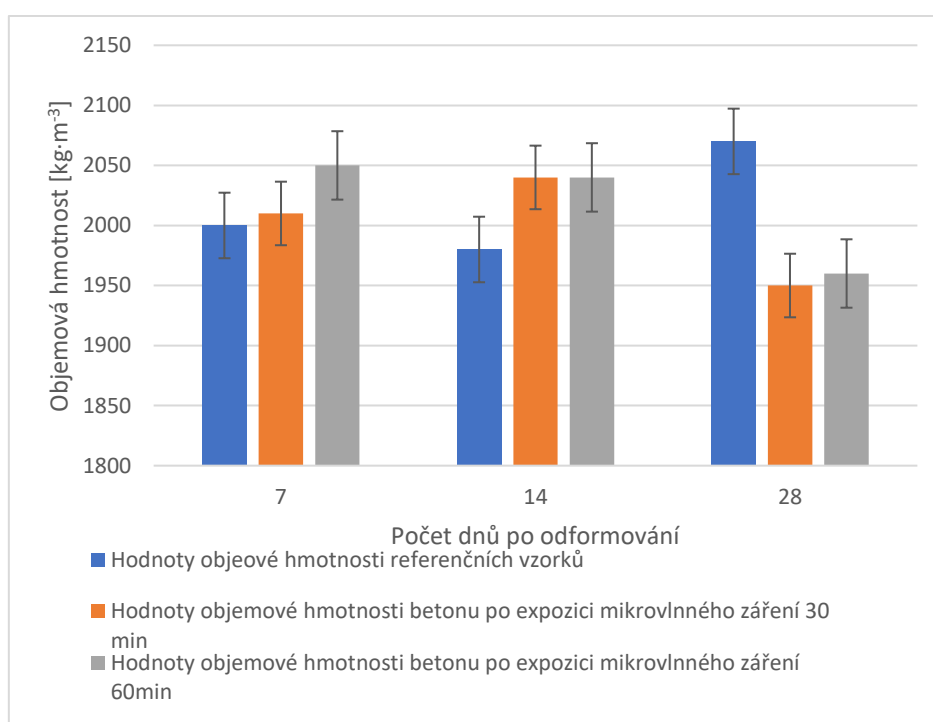
Obrázek 36. Hodnoty objemové hmotnosti vzorků po 7, 14 a 28 dnech od odformování. 54
