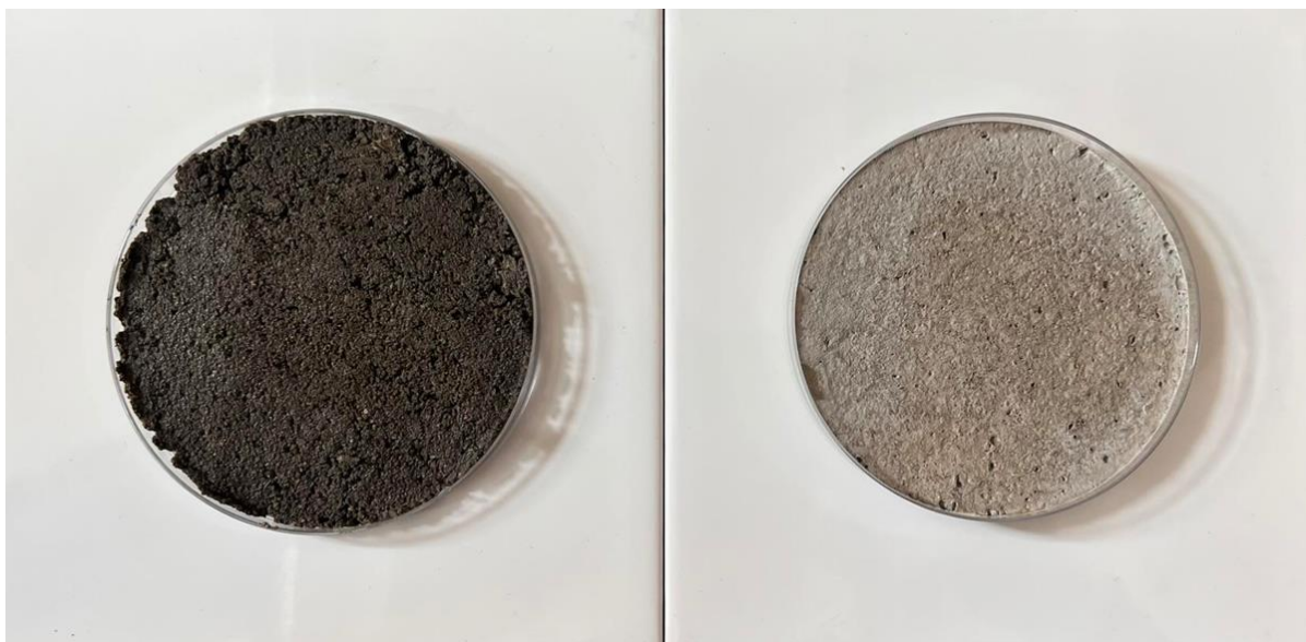
Obrázek 28 Fotografie vzorku betonu v kruhové misce, který tuhnul standardním způsobem po 60 minutách tuhnutí 54
