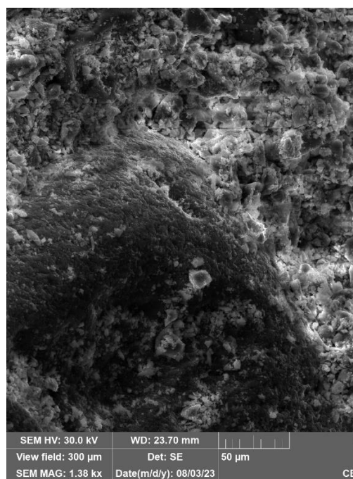
Fotografie 31 zobrazení cementu po 30 min expozice mikrovlnným zářením 54
