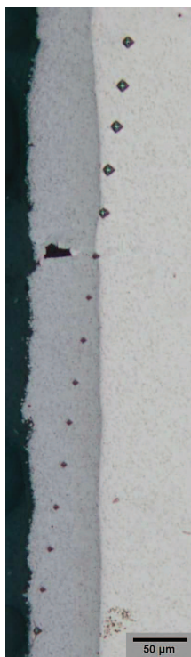
Obr. P.2.1 Závislost tvrdosti difuzní vrstvy na vzdálenosti pro směs A po difuzním žihání 0h.
