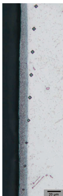
Obr. P.2.8 Závislost tvrdosti difuzní vrstvy na vzdálenosti pro směs C po difuzním žhání 2h.
