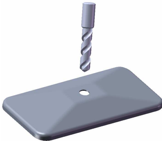
Obr.47 – vrtanie otvoru \Phi 8
