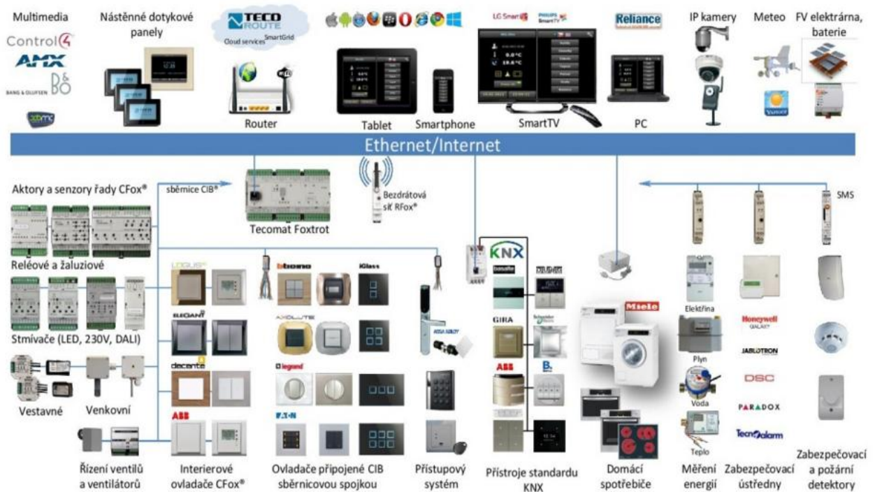
Obr. 3- 1 Struktura systému Tecomat Foxtrot [4]
