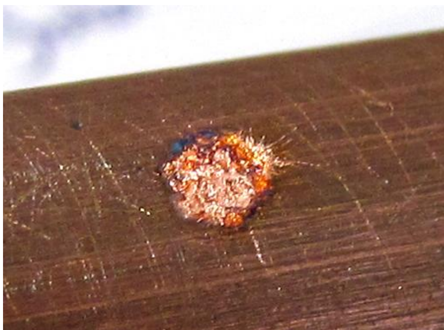
Obr. 4. 8: Detail opotřeбенého kontaktu (trubky) po experimentu.
