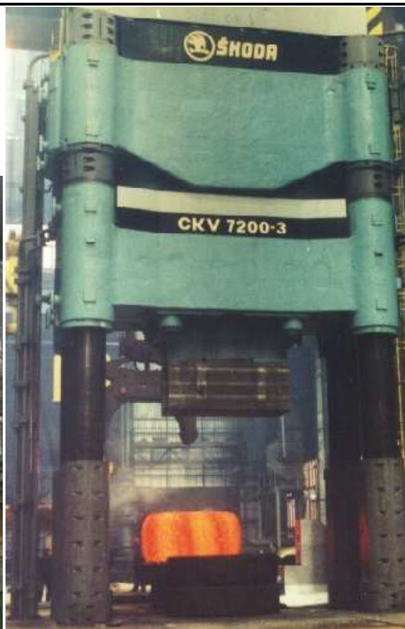
Obr. 1.2. Dvou-sloupový hornotlaký kovací lis CKVX (vlevo) a čtyř-sloupový hornotlaký kovací lis CKV (vpravo). [14], [17]
