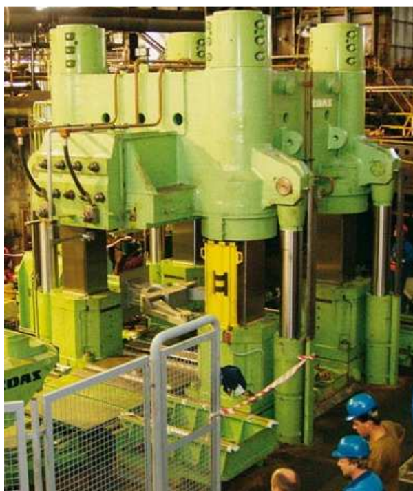
Obr. 1.1. Čtyř-sloupový dolů-tažný kovací lis CKZW (vlevo) a dvou-sloupový dolů-tažný kovací lis CKW (vpravo). [15], [16]
