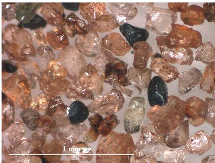
Obr. 5.3 Koncentrát připravený z granátu almandinu pro použití v technologii abrazivního vodního paprsku (30)
