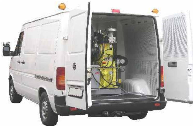
Obr. 4.6 Ukázka vodního čerpadla firmy Hammelmann integrovaného do automobilu (29)
