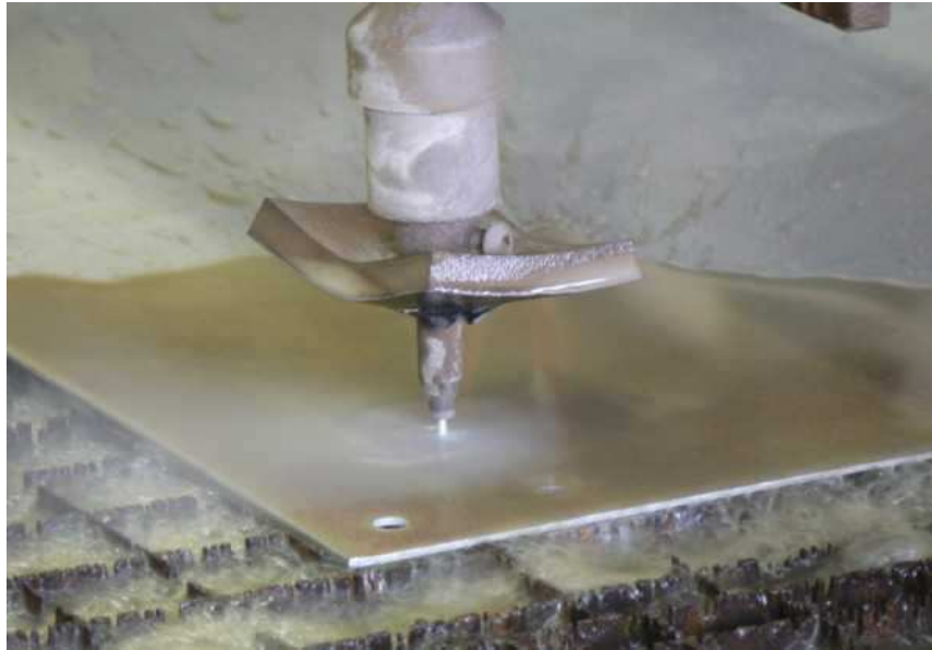
Obr. 4.2 Vodní paprsek při vrtání děr ve slavkovské firmě E-COM
