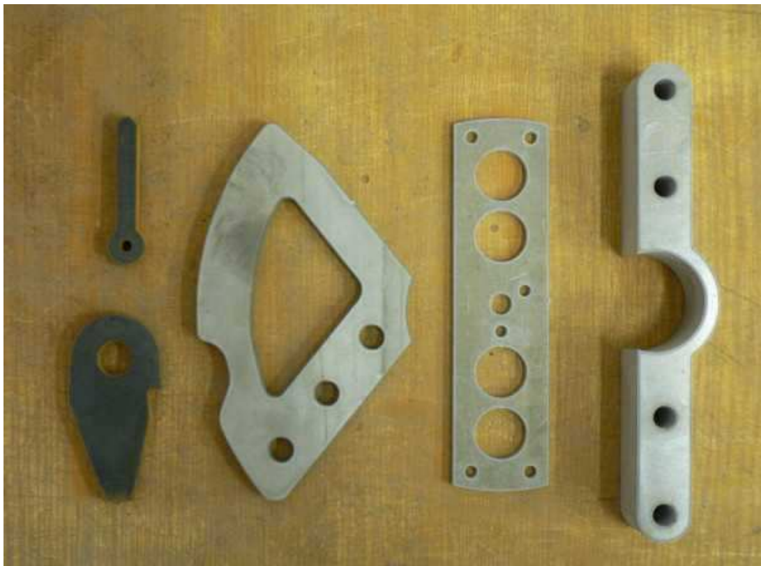
Obr. 4.3 Ukázky výřezků z plechu ve slavkovské firmě E-COM s využitím metody vrtání vodním paprskem
