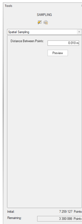
Obr. 5.1: Filtrácia mračna bodov [Autor]
