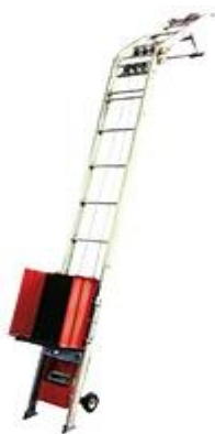
Obr. 5.11: Výtah stavební žebříkový Zdroj: https://www.dek.cz/
