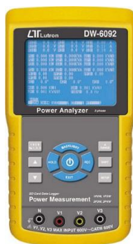
Obr. 42: Analyzátor výkonu LUTRON [47]
