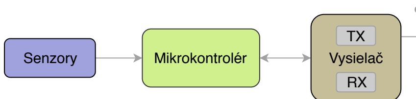
Obr. 2.1: Všeobecná schéma zariadenia pre zber a odosielanie dát. Zdroj: [10].
