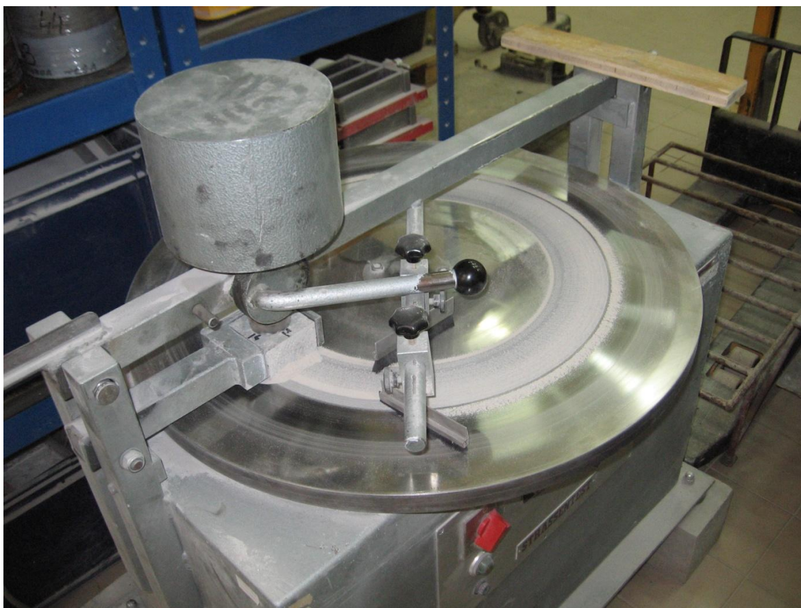
Obr. 1: Stanovení ohrusnosti betonu na Böhmově přístroji
