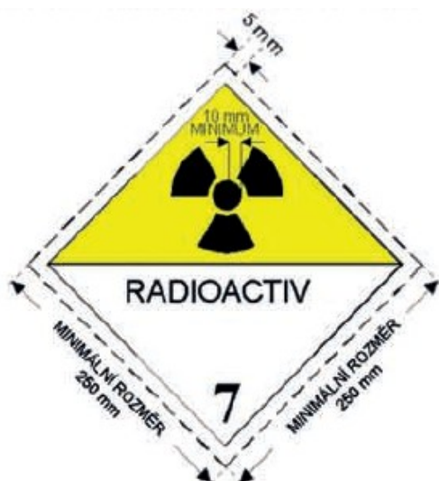
Obrázek č. 5: Bezpečnostní značka pro třídu 7, včetně nutných rozměrů [11]
