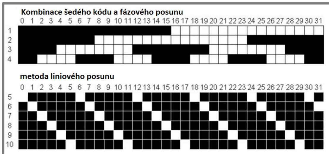
Obr. 3-5 Kombinace šedého kódu a fázového posuvu [52]
