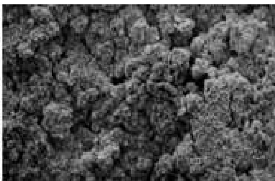
Obr. 12: Povrch desky akumulátoru bez sulfatace. 500 x zvětšeno [19]
