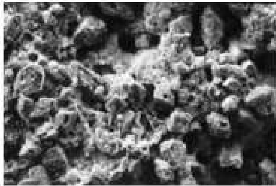
Obr. 13: Začínající sulfatace. 500 x zvětšeno [19]
