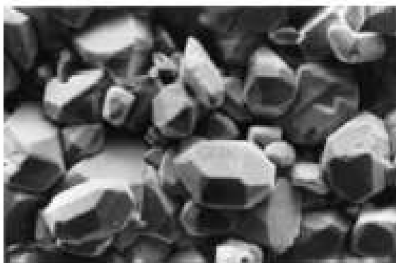
Obr. 14: Velká sulfatace zvětšení 550x [19]
