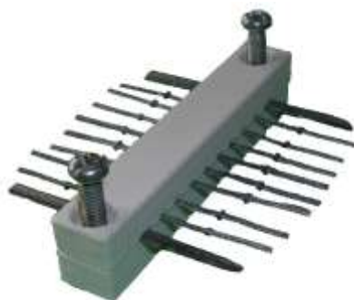
Obr. 21: Forma na držení olověných žeber
