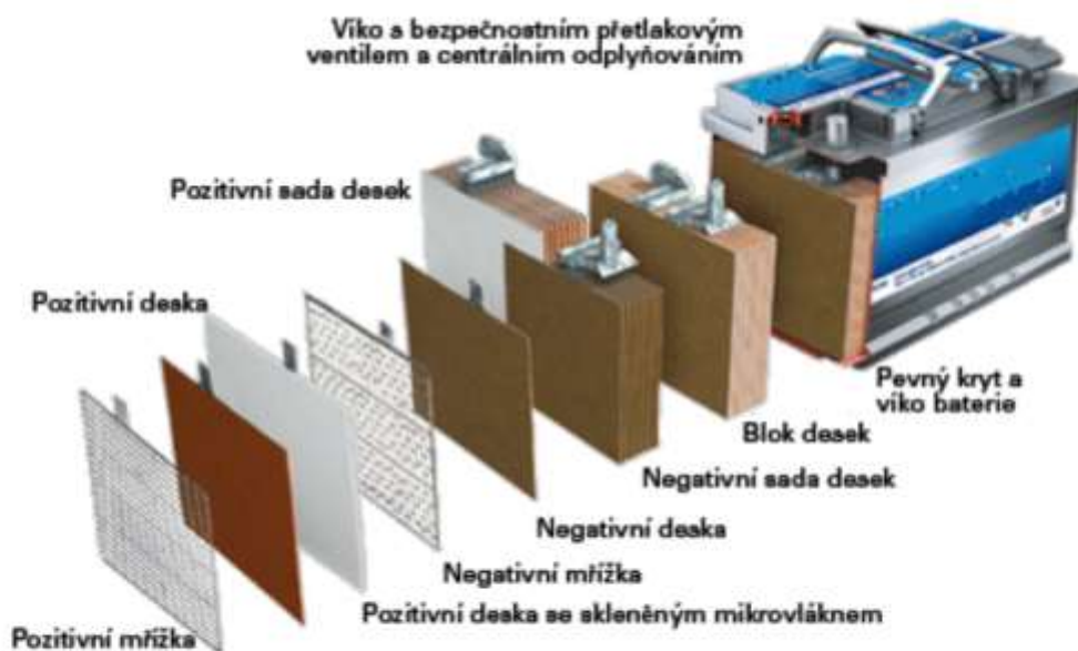
Obr. 2: Složení baterie [7]
