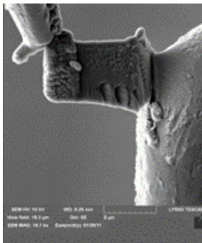
Obrázek č. 50: Detail přivaření vyjmuté lamely připevněné na měděnou síťku TEM držáku
