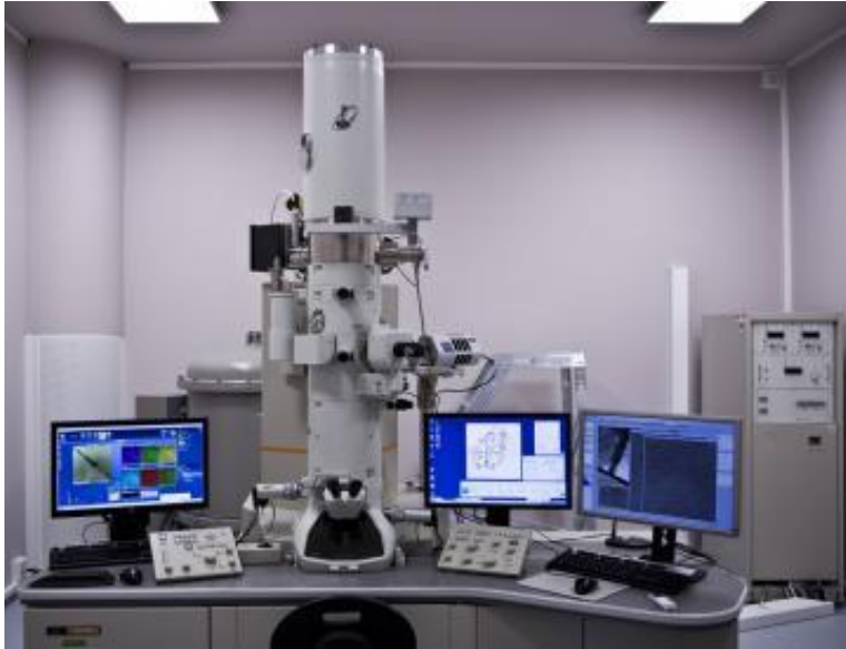
Obrázek č. 12: Transmisní elektronový mikroskop JEOL JEM-2100F [15]
