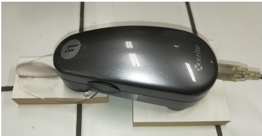
Obrázek 18: Měření odrazových spekter spektrofotometrem Eye-One
