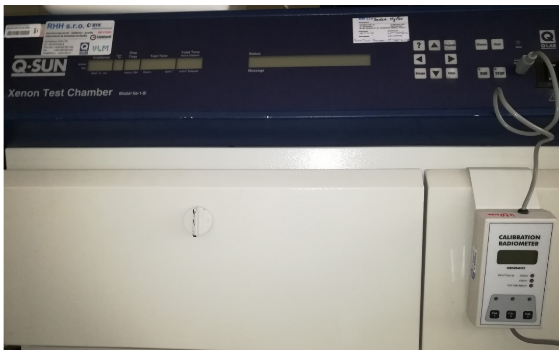
Obrázek 14: Zavěšený kalibrační radiometr (vpravo) na sluneční komoře
