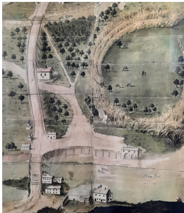
Obrázek 4 – Náčrt krajiny mezi Brandýsem n. L. a Starou Boleslaví [31]. Na skice je zachycen jez v hlavním řečišti a dřevěné opevnění pravého břehu Labe před dřevěným mostem.
