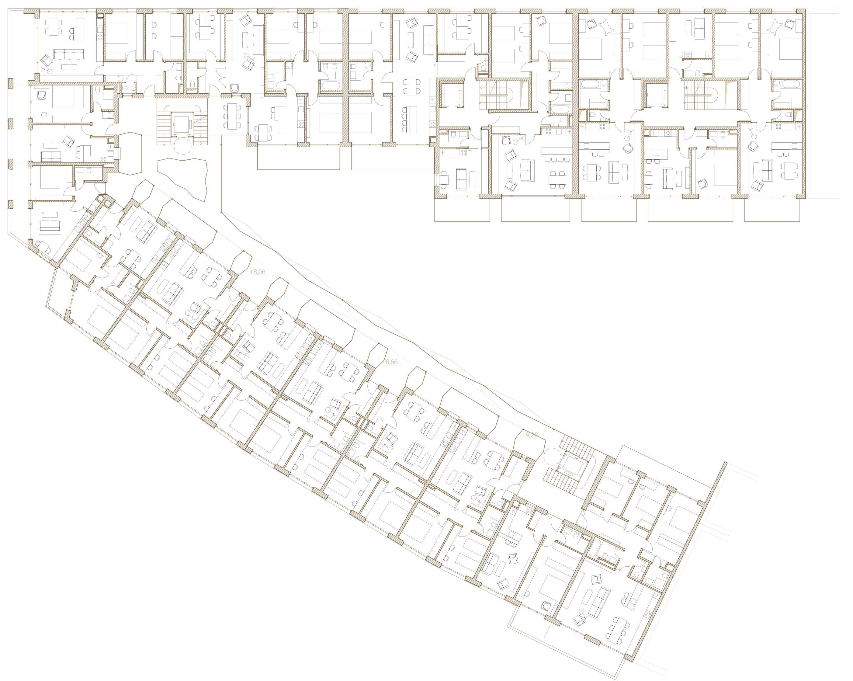
0 2,5 5 10 m půdorys typického podlaží objektů 1:200
