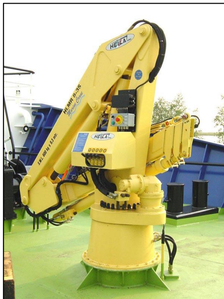
Obr. 3 Jeřáb HEILA s kloubovo-teleskopickým výložníkem [5]
