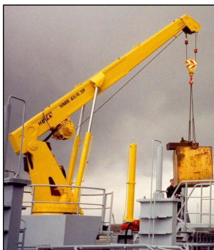
Obr. 4 Jeřáb HEILA s tuhým výložníkem [5]
