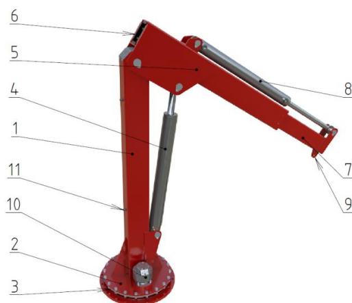
Obr. 6 Konstrukční řešení (1 – sloup, 2 – příruba sloupu, 3 – axiální jednořadé kuličkové ložisko, 4 – hlavní přímočarý hydromotor, 5 – rameno, 6 – vedení výložníku, 7 – výložník, 8 – vedlejší přímočarý hydromotor, 9 – oko uchycení břemene, 10 – radiální pístový hydromotor, 11 – úchyt hadic)
