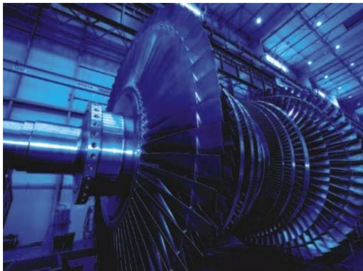
Obr. 4. 1: Arabelle parní turbína. Detailní pohled na rotor nízkotlaké akční parní turbíny [20]
