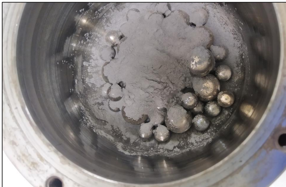
Obrázek 17: Mlecí miska s prášky a mlecími kuličkami
