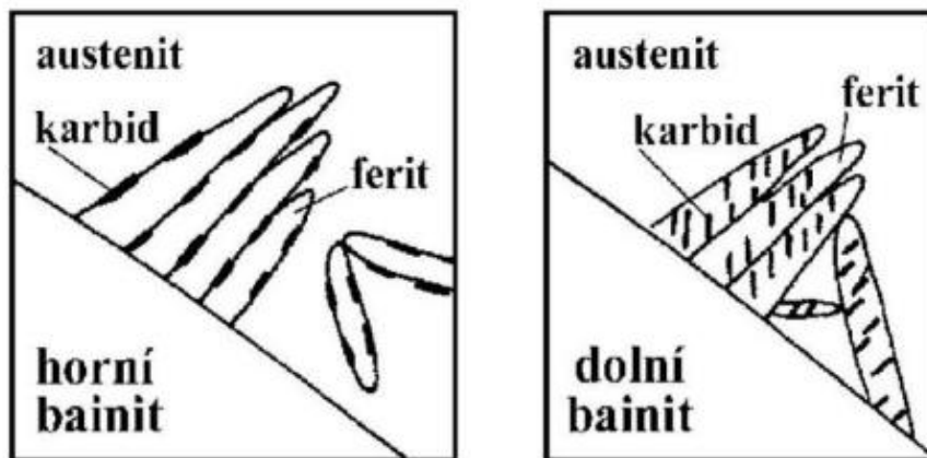
Obrázek 8: Struktura horního a dolního bainitu [6]
