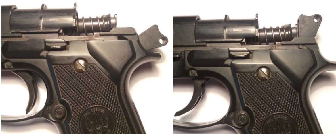
Obr. 1.4 Kohout v nataženém (vlevo) a nenataženém stavu (vpravo).
