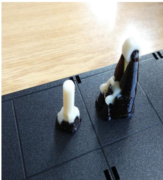
Obr. 3.6 Vytištěné součásti na stavební podložce.
