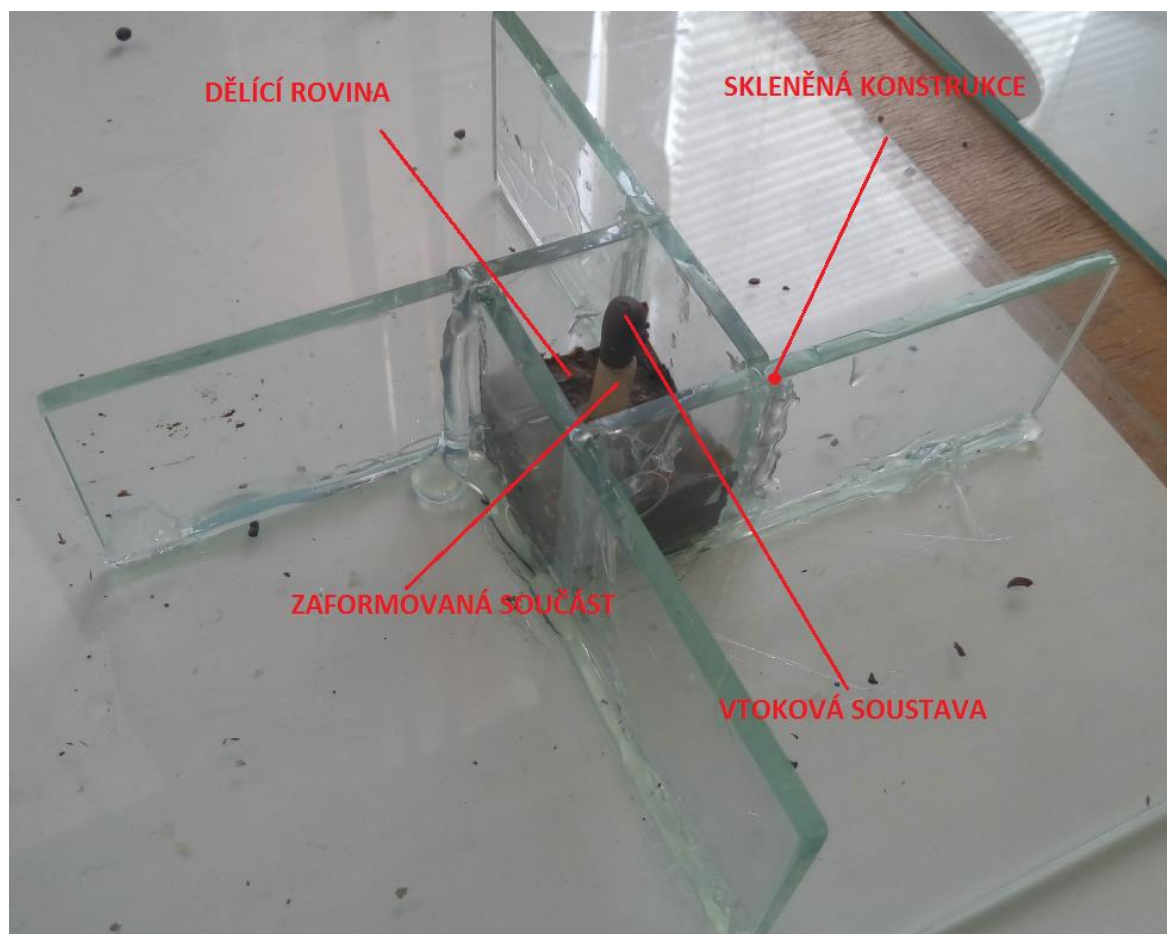
Obr. 3.10 Skleněná konstrukce připravená pro odlití první části formy.
