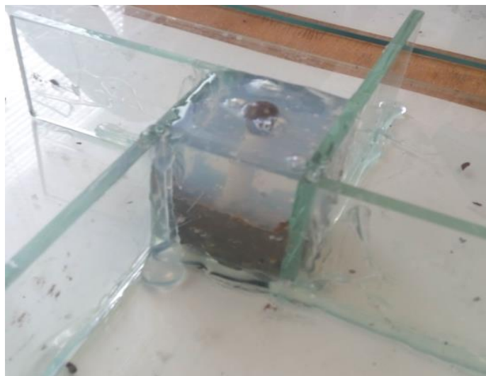
Obr. 3.11 Odlitá první část silikonové formy.
