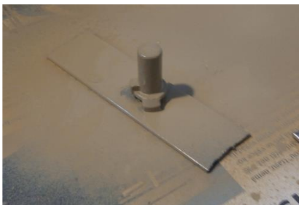
Obr. 3.9 Součást nastříkaná sprejem s tmelícím účinkem.
