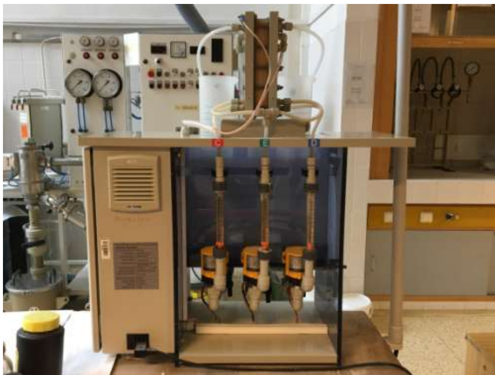
Obrázok 17: Zadná časť elektrodialyzačnej jednotky s čerpadlami a rotametrami
