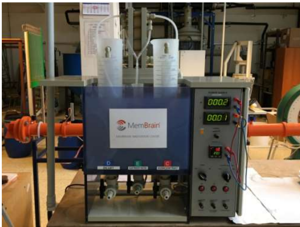
Obrázok 16: Zapojený elektrodialyzačný modul pripravený na meranie v laboratóriu
