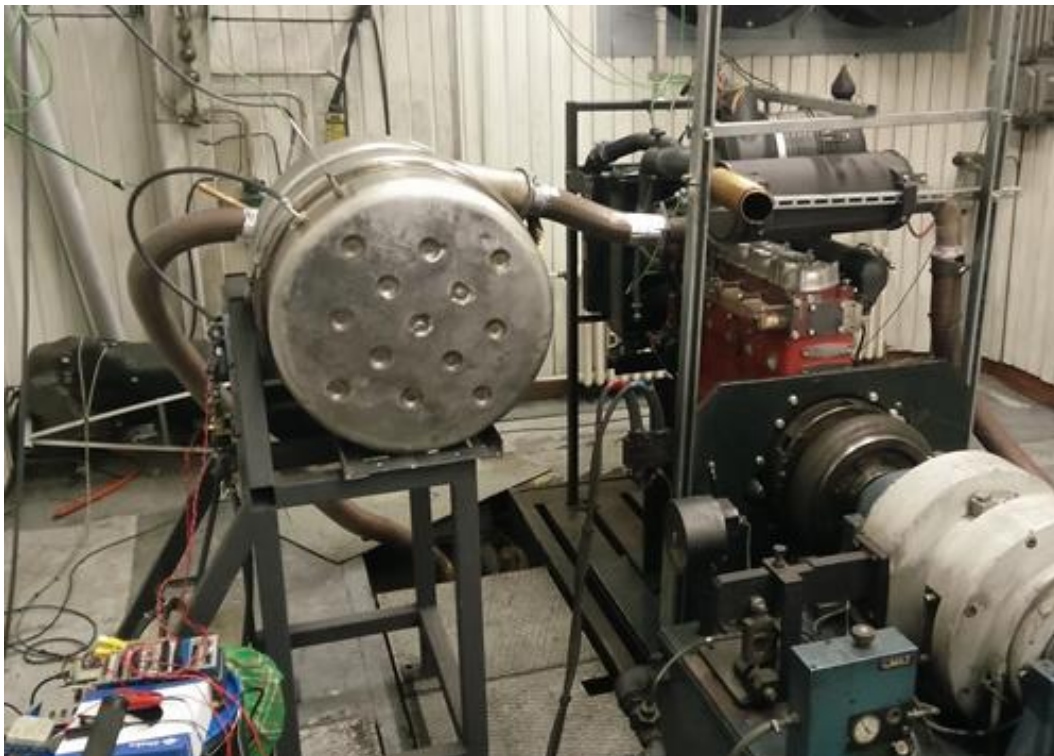
Obr. 44: Zkušební stanoviště se zástavbou SCR katalyzátoru
