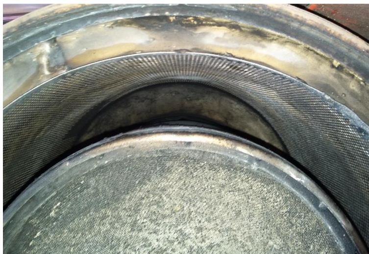
Obr. 28: Vnitřní konstrukce katalyzátoru, pohled na vnitřní část pláště katalyzátoru s aktivní plochou filtru z keramického substrátu
