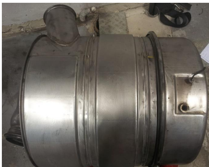
Obr. 30: Použitý SCR katalyzátor s otvorem pro trysku
