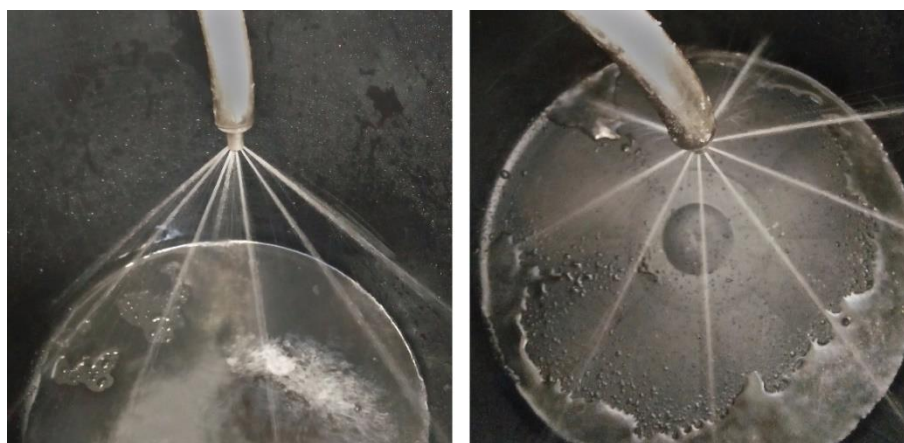
Obr. 41: Pohled na rozptyl trysky z boku a shora
