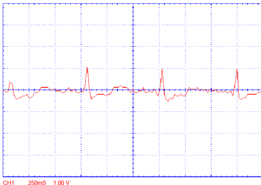
Obr. 21: Průběh signálu EKG při nastavení 250 ms/div a 1 V/div.
