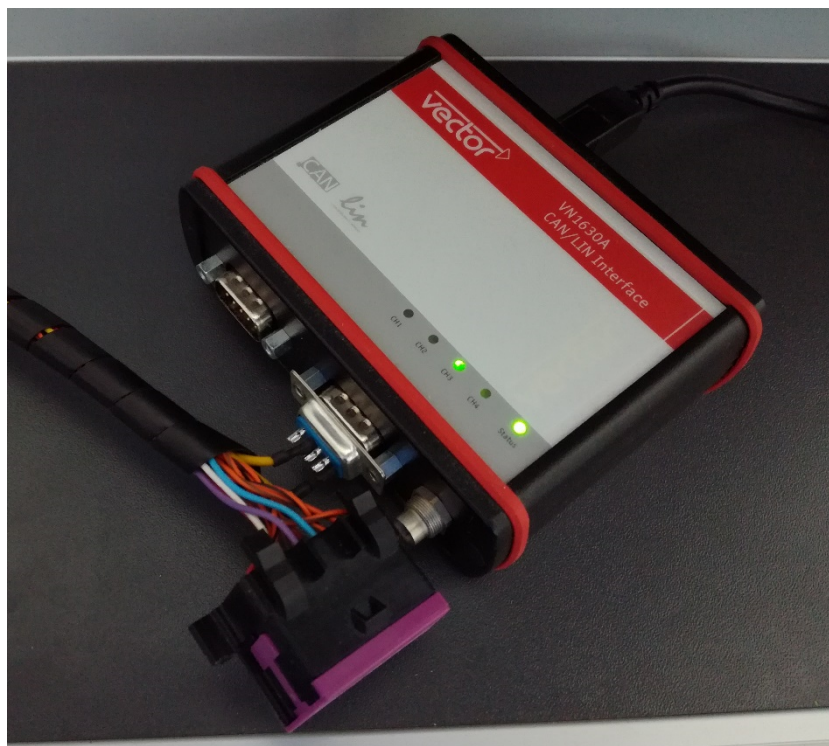
Obrázek 2.1 Zařízení CAN/LIN Interface VN 1630A firmy Vector s připojeným CAN kanálem
