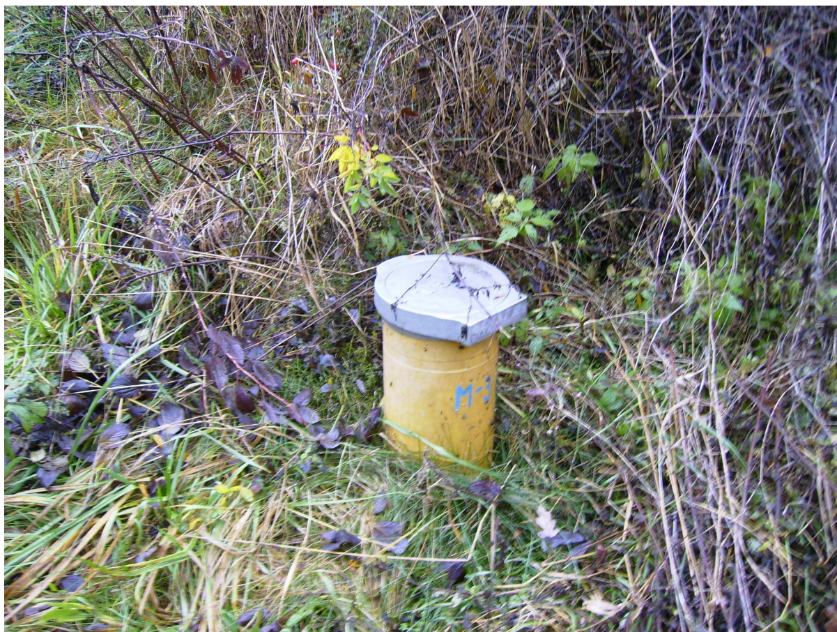
Obr. č. 2: Monitorovací vrt M3
