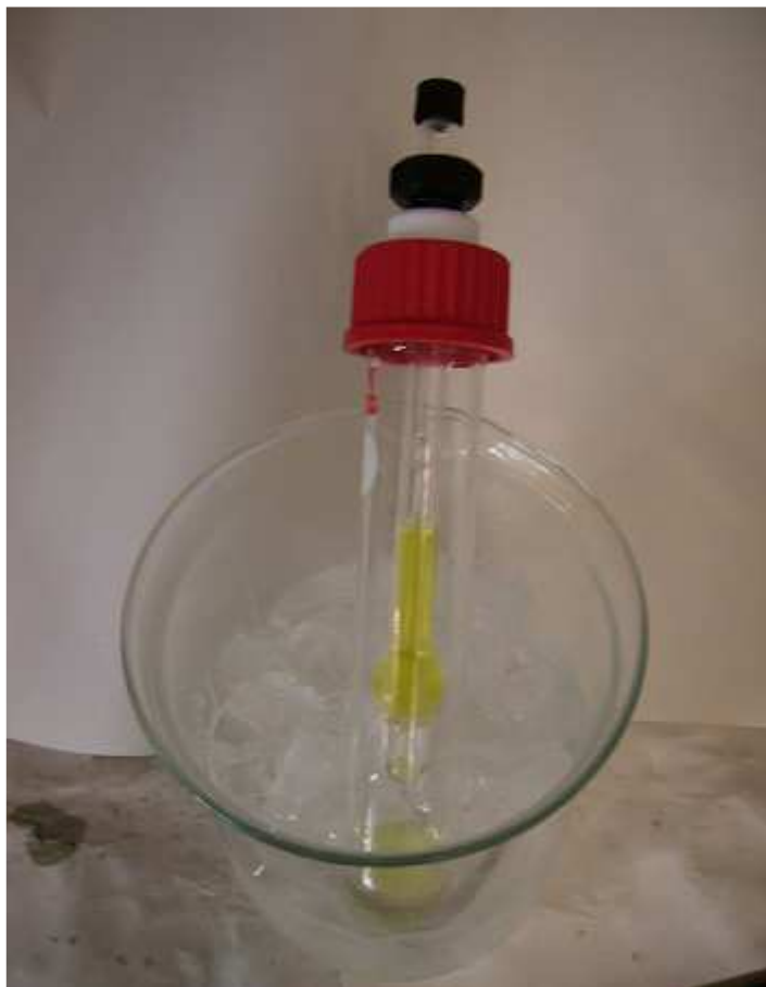
Obr. č. 18: Aparatura s vyvíjejícím se diazomethanem
