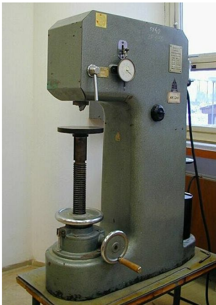
Obr. 1 Starší přístroj pro měření tvrdosti dle Brinella [5]
