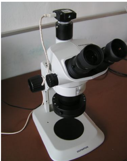
Obr. 1.6 Příklad mikroskopu využívaného k pozorování vtisku u Brinellovi zkoušky tvrdosti
