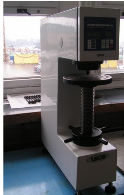
Obr. 2 Novější přístroj na měření tvrdosti dle Brinella
