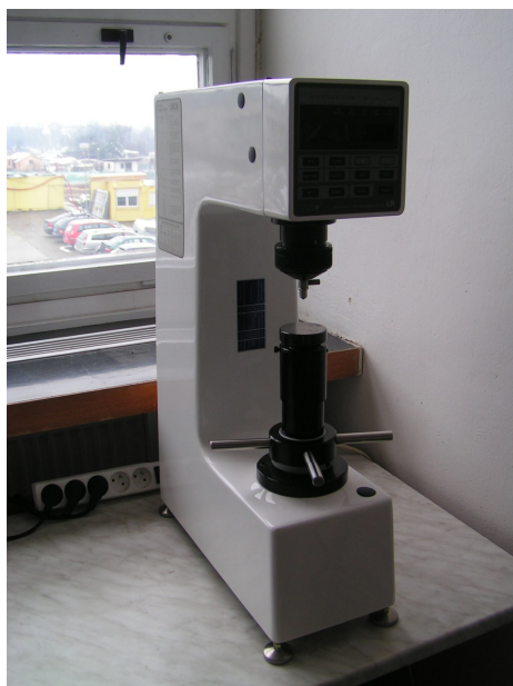
Obr. 4.1 Moderní přístroj na měření tvrdosti dle Rockwella
