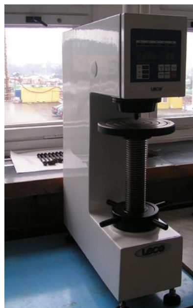
Obr. 4.2 Moderní přístroj na měření tvrdosti dle Brinella
