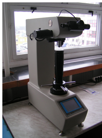
Obr. 4.4 Moderní přístroj na měření tvrdosti dle Vickerse
