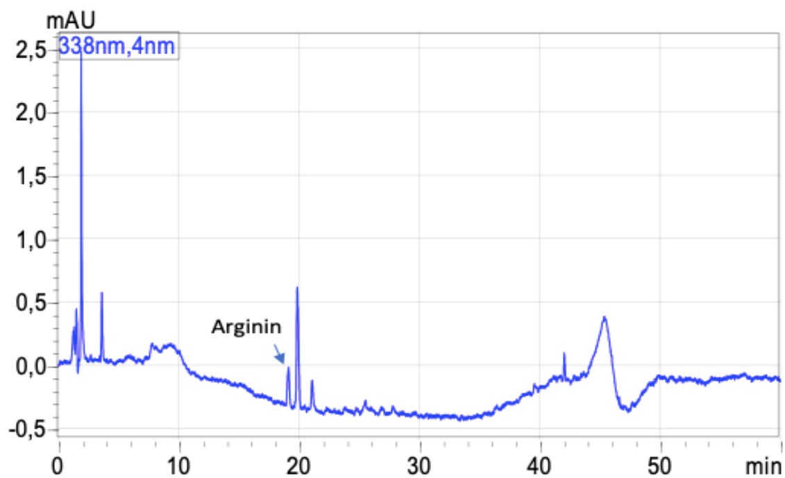
Příloha 15: Chromatogram adsorpční kapacity 0, 25 g navážky adsorbentu závislosti retenčního času [min] na odezvě [mAU].
