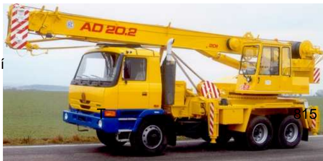
Obr. 7 – Pohled na autojeřáb Tatra 815 AD 20
