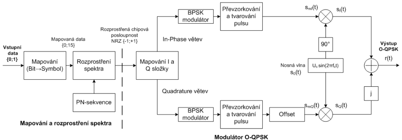
Obr. 3.9: Kompletní schéma vysílače systému ZigBee pro pásmo 2450 MHz.
