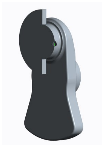
Obrázek 13 Polovina zalomení s hmotami rotační části ojnice (pro názornost je zobrazena pouze polovina v řezu)
