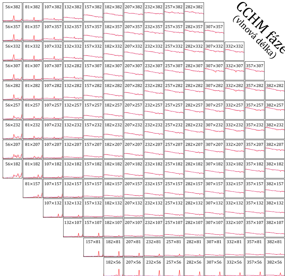
Obr. 3.4: Průběhy závislostí fázové odezvy jednotlivých struktur na vlnové délce lineárně polarizovaného dopadajícího světla. Osa x jsou hodnoty od 595 do 750 nm s intervalem 5 nm, osa y je fázový posuv od 0 do 2\pi . Popisky v jednotlivých čtvercích jsou ve formátu W \times L . Data jsou proložena lineární závislostí a průměrné hodnoty odchylek užitím statistických funkcí jsou R^2 = 0,55 a MADR = 0,13.
