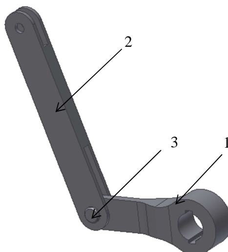
Obr. 26 Pákový mechanismus: 1 – ojnice, 2 – vidlice, 3 - čep
