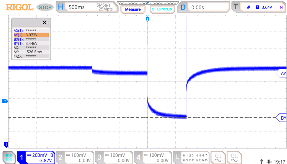
Obrázok 51 Priebeh napätia akumulátora pri meraní vnútorného odporu
