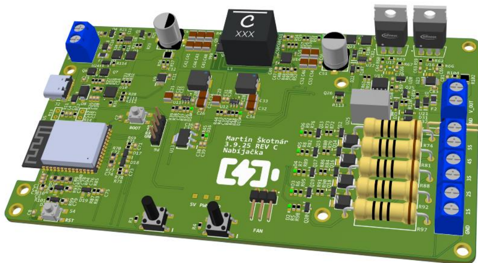
Obrázok 36 3D model dosky plošných spojov
