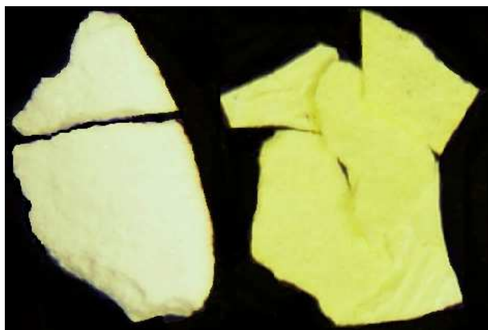
Obr. 10 Vzorek z filtračního koláče hydratačních produktů s obsahem chromu (vpravo) a bez chromu (vlevo)
