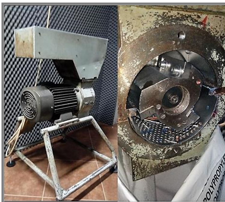
Obr. 3-1 Drtička AP112, vlevo detail pracovního prostoru
