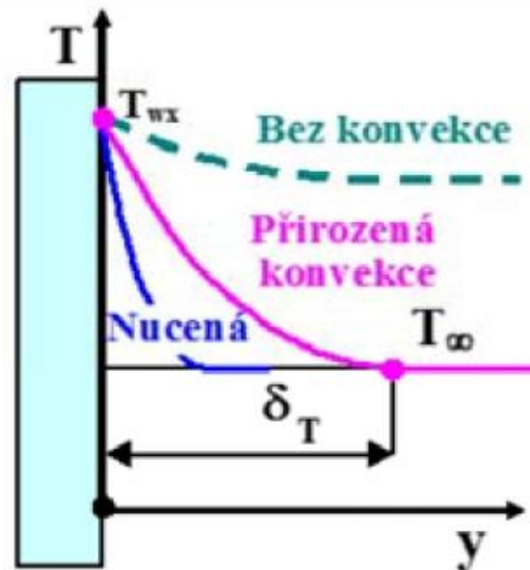
Obr. 5.2 Tvary tepelných medzných vrstiev [32]
