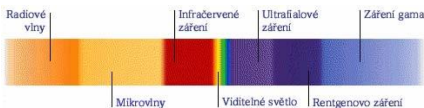
Obr.2.8 Oblasť IR žiarenia v spektre elektromagnetického žiarenia [15]
