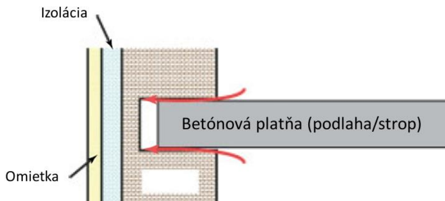
Obr. 5.9 Spojenie oboch typov tepelných mostov [5]
