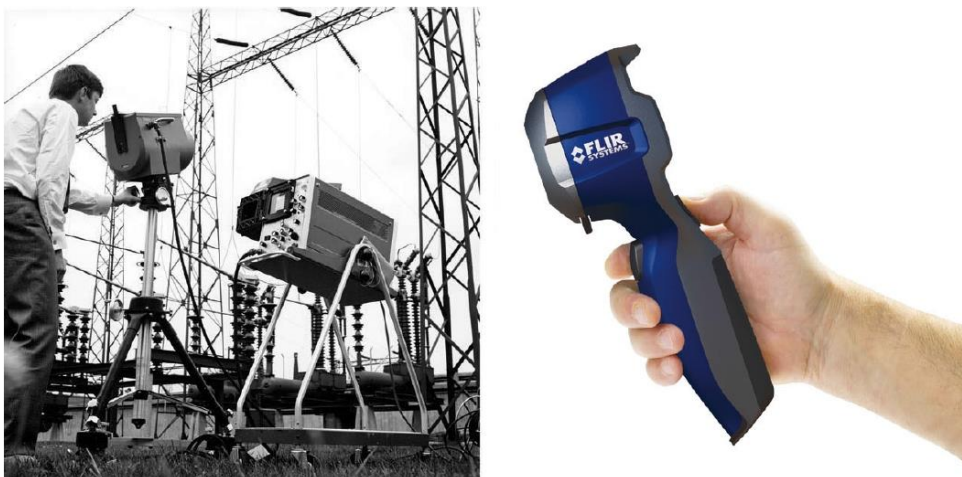
Obr. 3.6 VĽAVO: Model termovíznej kamery z roku 1969. Váha kamery bola 25 kg, ďalšie príslušenstvo vážilo 40 kg. Taktiež bol potrebný elektrický generátor a 10 l tekutého dusíku. VPRAVO: Model z roku 2009 s váhou 0,34 kg vrátane batérie. [6]
