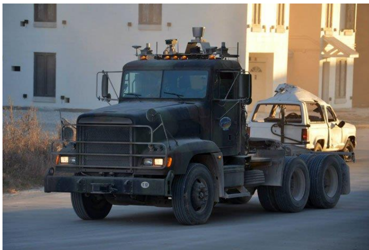
Obr. 5: Vozidlo M915 vybavené systémem AMAS během testů z roku 2014. [15]
