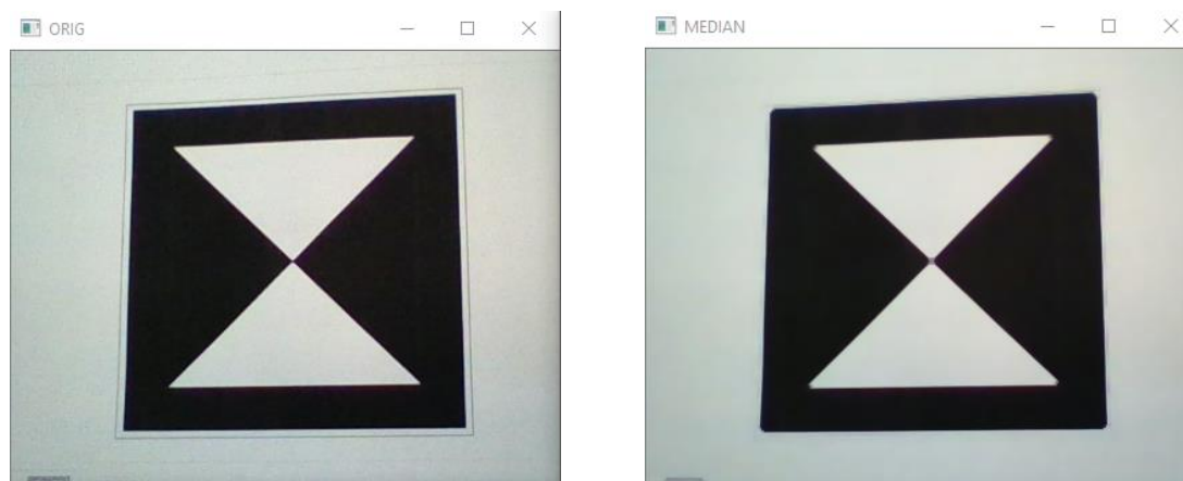
Obr. 17: Funkce mediánového filtru na ilustrační fotografii. Původní obraz (vlevo), po aplikaci filtru (vpravo).
