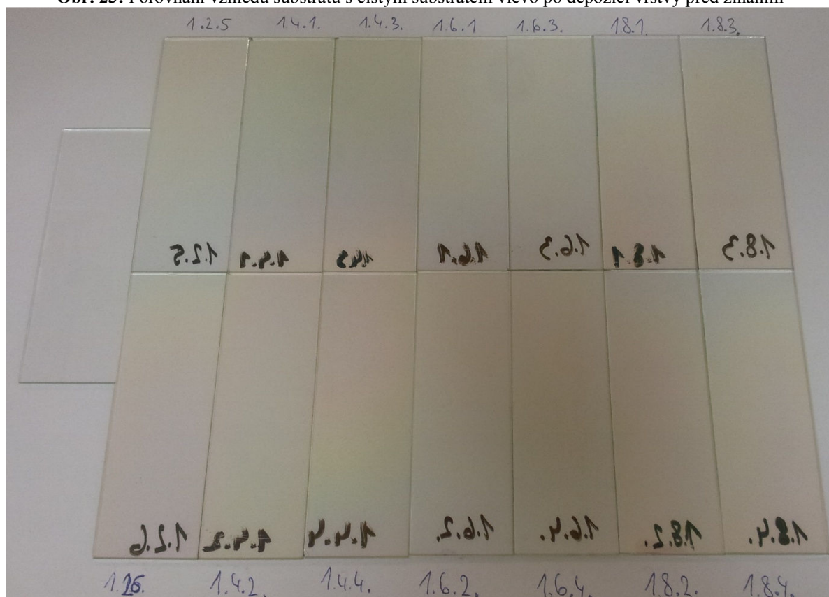
Obr. 24: Porovnání vzhledu po 60 min. žihání s čistým substrátem vlevo
