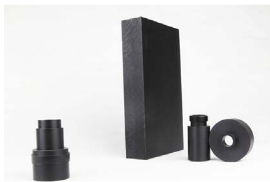
Obr. 16 Příklady polotovarů z materiálu POM [14]
