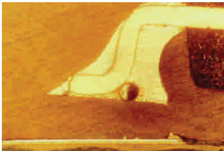
Obrázek 2.25 Oddělení spoje od pájené plochy [39].
