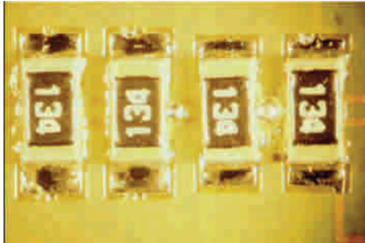
Obrázek 2.20 Kuličky po stranách čipových součástek [39].
