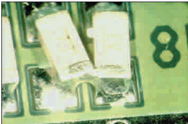
Obrázek 2.12 Zkrat vytvořený chybou v procesu [39].
