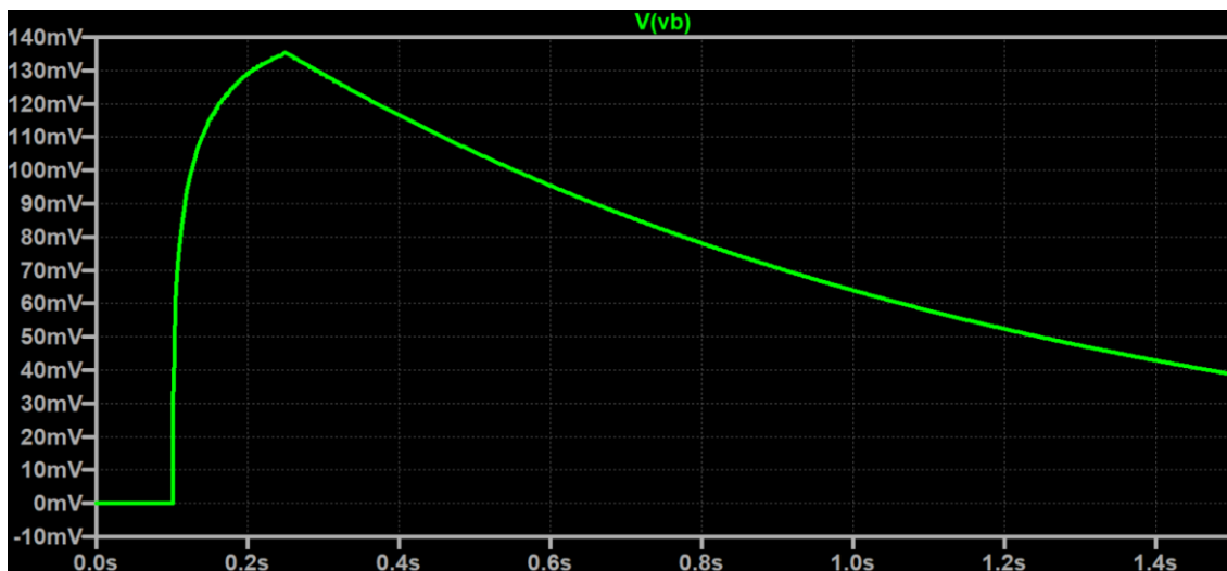
Obrázek 4.6 Vybíjení kondenzátoru C3 po vypnutí budícího zdroje
