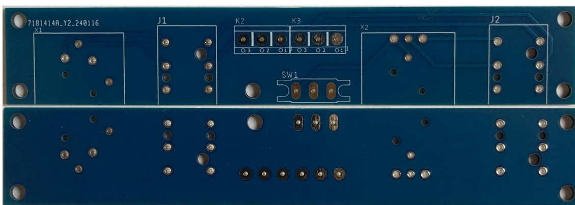
Obrázek 5.6 Hotová deska pro konektory – horní a dolní strana
