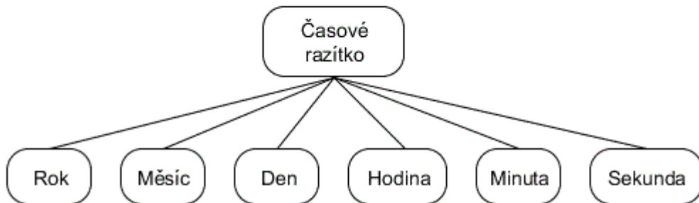
Obrázek 3.1: Varianty konstrukce stromu struktur pro časové razítko – data uložena v listech
