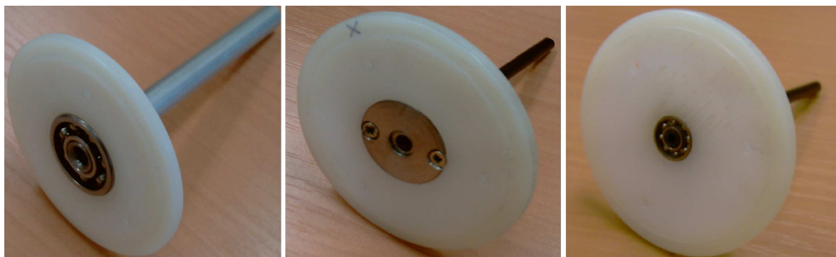
Obrázek 6-6 Odleva: uložení kuličkového ložiska Kinex, klzného ložiska a dvou ložisek SKF
