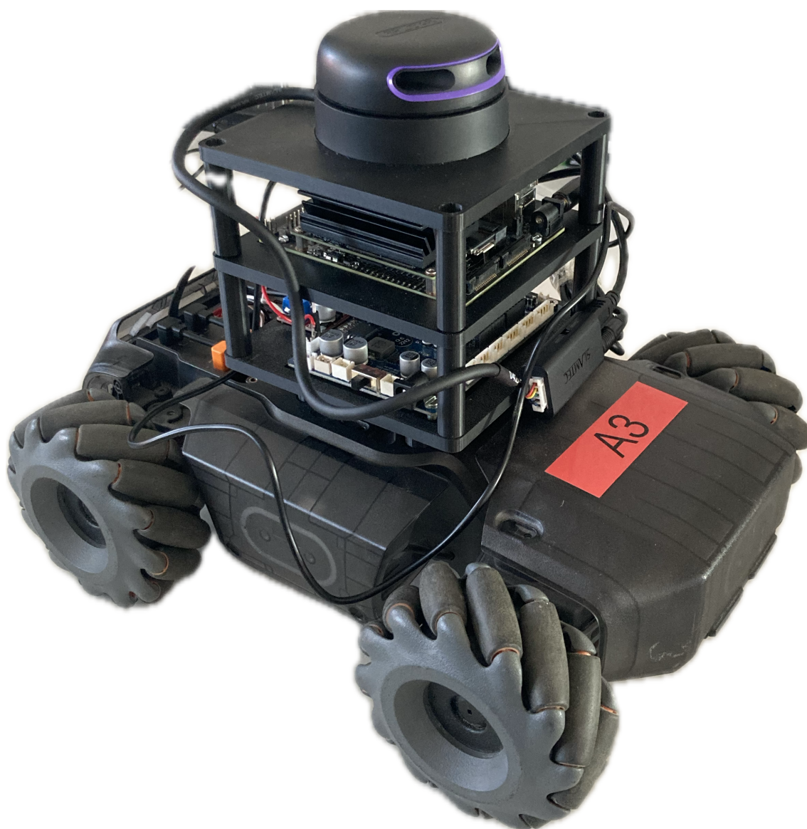
Obr. 3.8: Robomaster S1 s vytvořeným rámcem pro elektroniku
