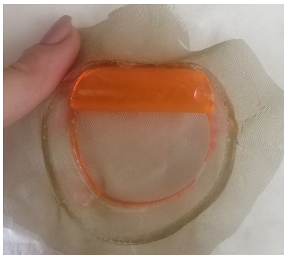
Obr. 37: Vzorek který se protrhl během experimentu horizontálních difúzních cel
