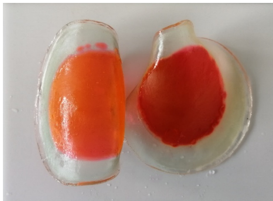
Obr. 36: Vzorok čistého poly-HEMA gelu a gelu s přidavkem PSS po experimentu horizontálních difúzních cel
