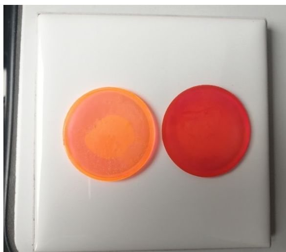
Obr. 21 Vzorky pro měření na datacoloru umístěné na měřicí podložní kachličce
