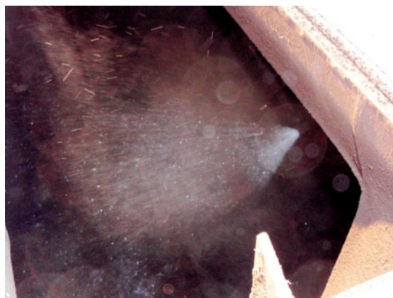
Obr.13 Test trysky pro čištění odlučovače
