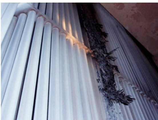
Obr. 10 Úsady na výstupu SP z MP
