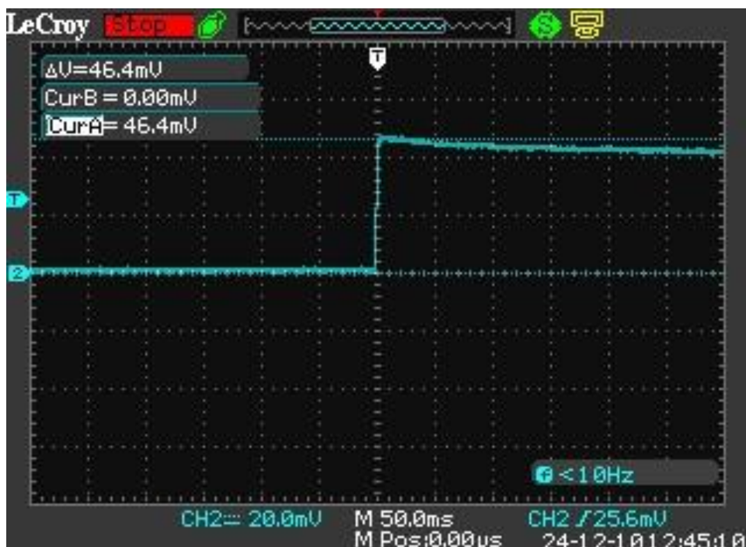
Obrázek 4.4 Nárůst napětí na bočníku v obvodu článku č.19.
