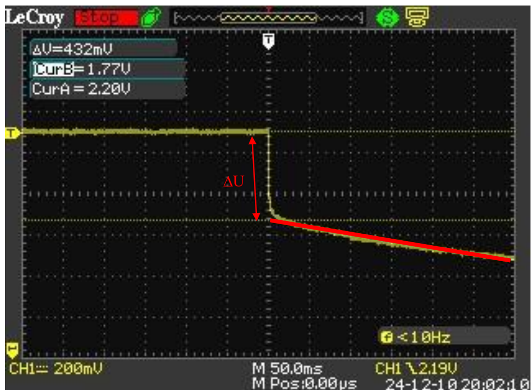
Obrázek 4.3 Příklad odečtené hodnoty poklesu napětí na článku č.19.
